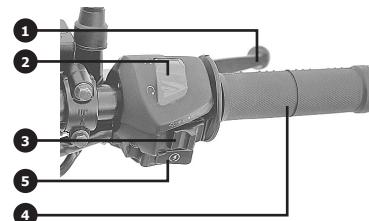
В положении  $\text{--}00\text{--}$  горят стояночные огни. Для обозначения на стоянке вне дороги и ночью мотоцикла необходимо включать этот выключатель.
