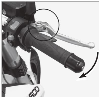
Der Bremshebel ist mit einem Knopf "1" zur Justierung seiner Lage ausgestattet. Um den Abstand zwischen dem Bremshebel und dem Gasgriff zu regeln, den Knopf im Uhrzeigersinn oder gegen den Uhrzeigersinn drehen. Bei Drehen gegen den Uhrzeigersinn wird der Hebel näher, bei Drehen im Uhrzeigersinn weiter entfernt eingestellt. Sicherstellen, dass die am Regelquadranten eingestellte kor-
