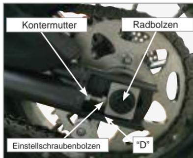
4. Sollte die Kettenspannung nicht in Ordnung sein, muss sie wie folgt nachgestellt werden.
