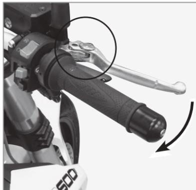
La maneta del freno está equipada con un pomo de regulación "1" de la posición. Para regular la distancia entre la maneta del freno y el mando del acelerador, gire el pomo en sentido horario o antihorario; si se gira en sentido antihorario la maneta se acerca, por el contrario si se gira en sentido horario la maneta se aleja. Asegúrese de que la regulación correcta configurada en el cuadrante de regula-
