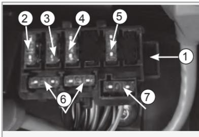
Die Sicherungen befinden sich im Bereich des Batteriefachs. Im Bild sind folgende Sicherungen zu sehen:
