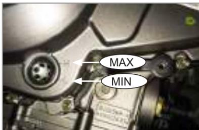
wie in der Abbildung dargestellt. Wenn der Ölstand nahe beim Minimum liegt, Motoröl nachfüllen, wie im Abschnitt "Nachfüllen Motoröl" beschrieben. Es empfiehlt sich, Öl Petronas Power Speed 4T zu verwenden.
