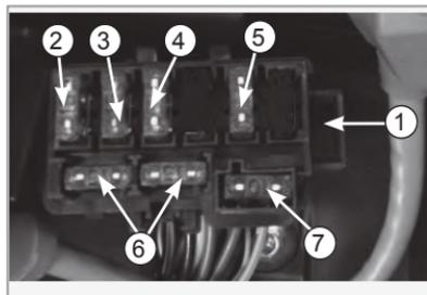
Les fusibles se trouvent en correspondance du logement batterie. Dans la photo, on peut distinguer les fusibles suivants:
