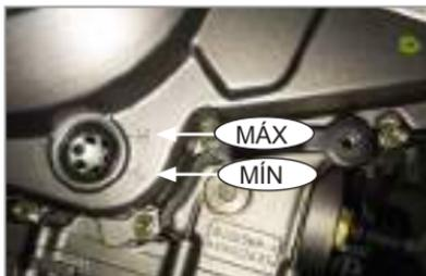
Si el nivel se encuentra cerca del mínimo, rellene con aceite de motor tal y como se describe en la sección "Rellenado aceite del motor". Se aconseja utilizar aceite **Petronas Power Speed 4T**.
