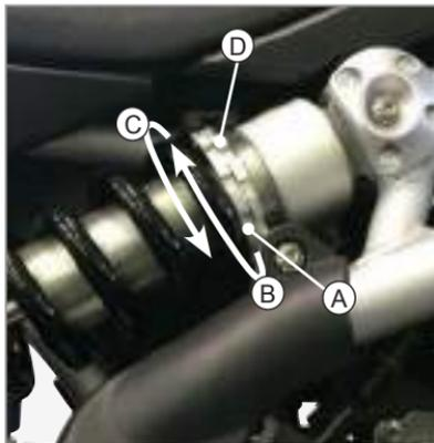
Para **reducir** la precarga del muelle y que, de tal forma, la suspensión sea más blanda, gire la abrazadera de regulación "A" en dirección (C). Al finalizar la regulación, apriete con la contraabrazadera "D".
