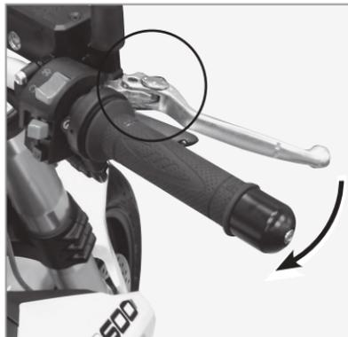
La leva del freno è munita di un pomello di regolazione "1" della posizione. Per regolare la distanza tra la leva del freno e la manopola dell'acceleratore, girare il pomello in senso orario o antiorario, ruotandolo in senso antiorario la leva si avvicina, in senso orario la leva si allontana. Accertarsi che la regolazione corretta impostata sul quadrante di regolazione sia allineata con il riferimento "2" sulla leva del freno.
