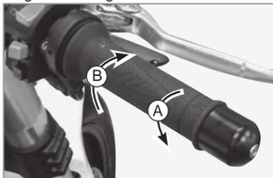
**Schalten der Gänge:** Das Fahrzeug ist mit einem 6-Gang-Getriebe ausgestattet. Die Lage der einzelnen Gänge ist in der Abbildung dargestellt. Je nach Fahrbedingungen den richtigen Gang wählen.
