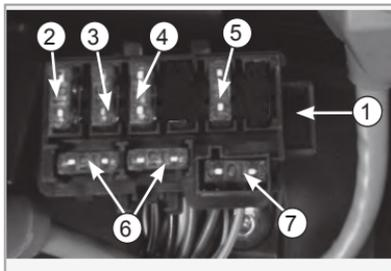
Los fusibles se encuentran en el compartimento de la batería. En la foto se distinguen los siguientes fusibles:
