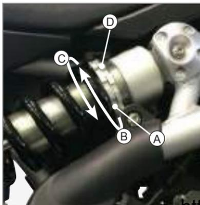
Zum **Verringern** der Vorspannung, d.h. um eine weichere Federung zu erzielen, die Einstellmutter "A" in Richtung (C) drehen. Nach erfolgter Einstellung, die Kontermutter "D" festziehen.
