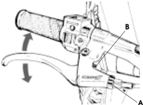
**Nota:** Sulla leva esiste un regista **B** per la regolazione della posizione delle leva stessa.
