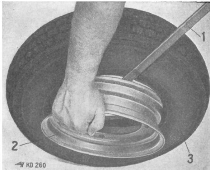
Reifenwulst über den Felgenrand. Dann Luftschlauch herausnehmen, Rad aufstellen und mit Montierhebel die zweite Reifenwulst (siehe Bild 17) über den Felgenrand drücken und den Reifen seitlich von der Felge abziehen.
