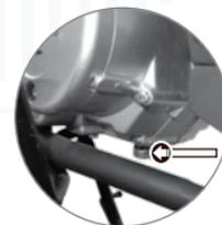
Imagen 15. Ubicación del tornillo de drenado.
