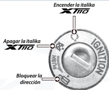
Imagen 8. Interruptor de encendido y bloqueo.
