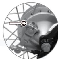
Imagen 19. Desgaste de freno delantero.
