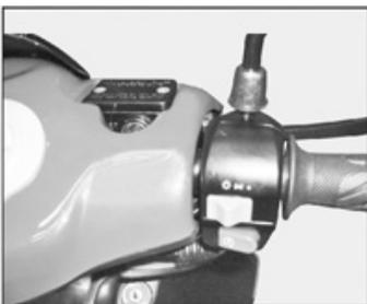
Betätigen Sie den Hebel der Hinterradbremse, bis der Widerstand steigt, und messen Sie, ob sich der weitere Hebelweg im vorgeschriebenen Bereich befindet.
